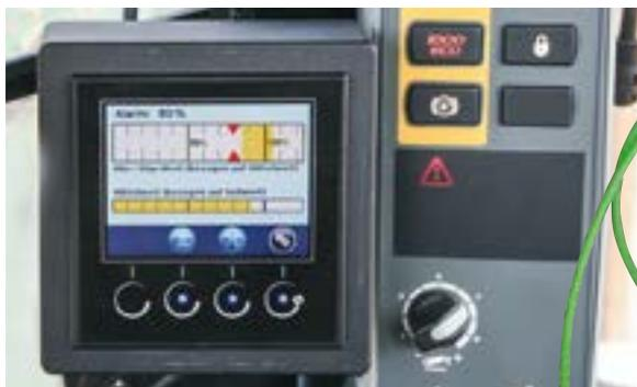
Die Anzeige- und Bedieneinheit zeigt die aktuelle Durchflussmenge als gelben Balken an. Die Alarmschwelle ist einstellbar.
