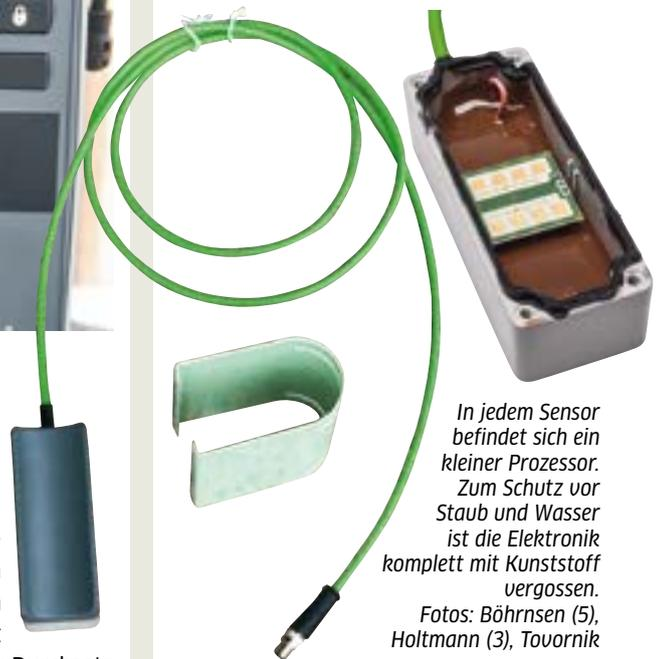
In jedem Sensor befindet sich ein kleiner Prozessor. Zum Schutz vor Staub und Wasser ist die Elektronik komplett mit Kunststoff vergossen.
