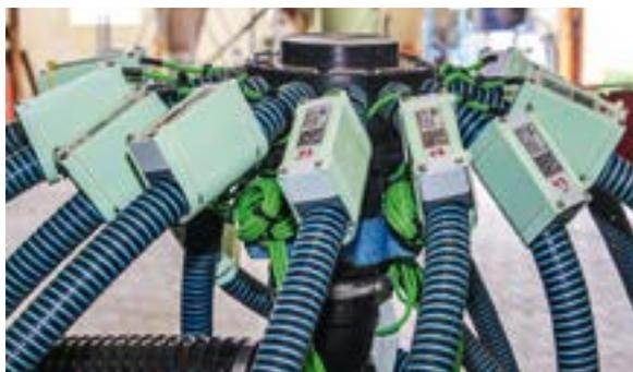
Die Sensoren an den Saatgutschläuchen überwachen den Durchfluss und schlagen Alarm, sobald kein Saatgut fließt.
